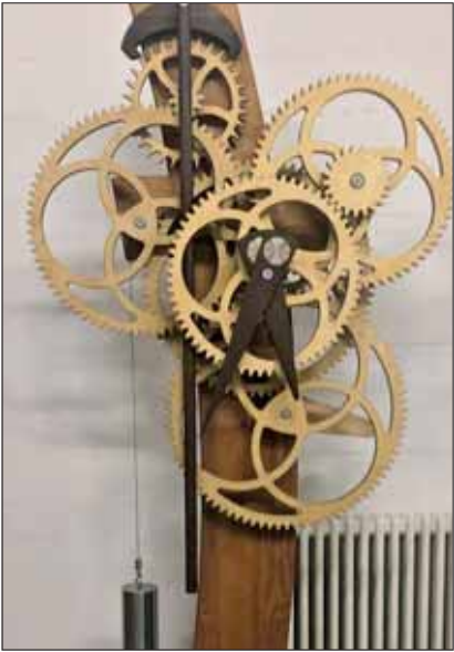
Funktionierende Standuhr aus Kirschbaum, Pappelsperholz und Eiche
